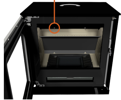
Retirer le déflecteur de fumée en le soulevant vers l'avant et en l'inclinant pour le dégager de ses fixations.
