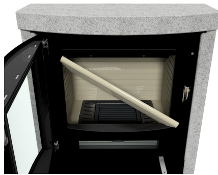
Ta bort rökavvisarplåten genom att dra och luta den framåt.
