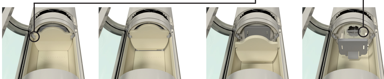
Retirez le fusible, puis retirez la plaque déflectrice de fumée en la tirant vers l'avant et vers le bas.
