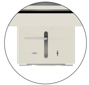
Vanne d'air fermée
