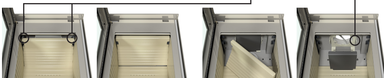
Retirez le fusible, puis retirez la plaque déflectrice de fumée en la tirant vers l'avant et vers le bas.
