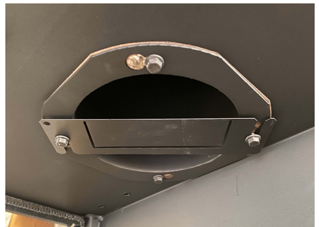
2. Monteer de begrenzer volgens het formulier en draai vervolgens de twee bouten diagonaal vast.
